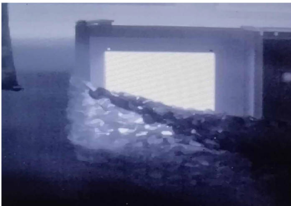
Applicazione di una rete di mascheramento su piastra riscaldante alla temperatura di 40°C
